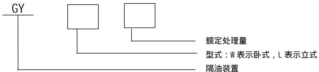
示例：GYW10 指处理量为  $10\text{m}^3/\text{h}$  的卧式隔油装置。
